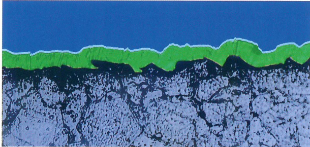
Klassische Mattverchromung z.B. für Stahl oder Messing (500:1)
