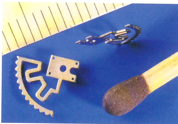
Pièce en nickel électroformée par la méthode LIGA-UV, illustrant la grande liberté de dessin. L'épaisseur de la pièce est d'environ 200 \mu\text{m} .
